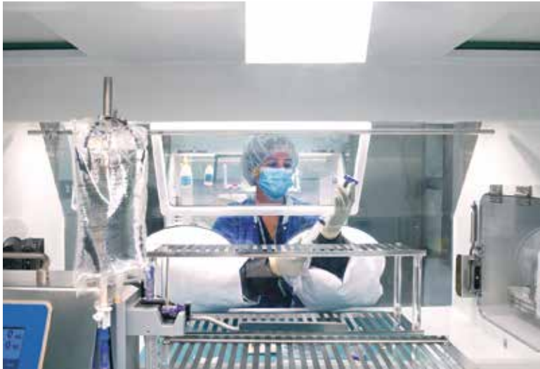
figure 2 – Préparation de médicaments injectables en environnement stérile (isolateur / zone à atmosphère contrôlée). Illustration des exigences PIC/S en production stérile : maîtrise de l'asepsie, protection du personnel, traçabilité et sécurisation des préparations de chimiothérapie et d'immunothérapie.
